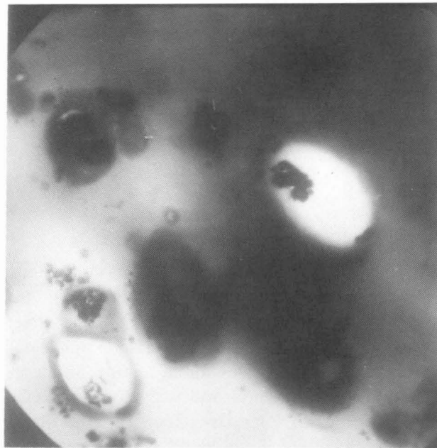
Figura 2. Microscopia eletrônica de transmissão de semi-IPN de PPI/EPDM preparadas a partir de matrizes contendo 33% de CuCl 2 (< 150 μm) e vulcanizadas com 0,8% de peróxido de dicumila. Aumento de 12.000 vezes.
