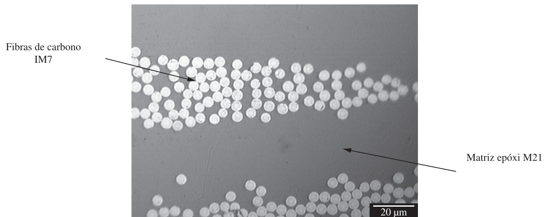
Figura 5. Detalhe da seção transversal do laminado mostrando a seção circular das fibras de carbono e as regiões ricas em resina epóxi livres de defeitos.
