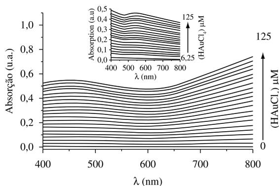
**Figura 2.** Espectro de absorção de UV-vis de solução coloidal de nanocompósito como função da concentração de  $\text{HAuCl}_4$  na presença de SDS. No quadro inserido ao centro: resposta óptica na ausência de SDS.
