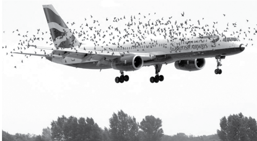
Figura 2. Curso de aterrissagem de uma aeronave comercial rodeada por um bando de pássaros, condição essa que pode resultar em danos de estruturas pelo choque com pássaros (Fonte: http://w1.rob.com/pix/oops?page=3 , Acesso em: março de 2007).
