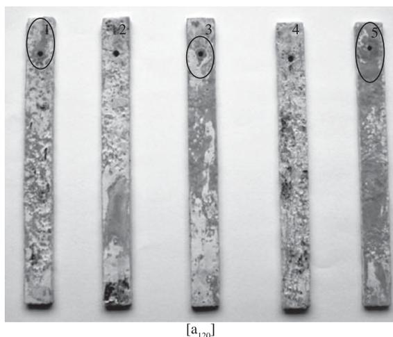
**Figura 4.** Fotos da blenda PHBV/Ecoflex® (70/30) no tempo zero [a<sub>0</sub>], a 60 [a<sub>60</sub>] e 120 [a<sub>120</sub>] dias de ensaio de biodegradação.
