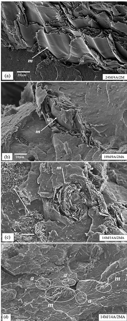
**Figura 2.** Micrografias para os compósitos utilizando duas fases dispersas e matriz de PEAD modificado com o agente compatibilizante PEAD-g-MA. Onde *a* é alumina e *m* é madeira.
