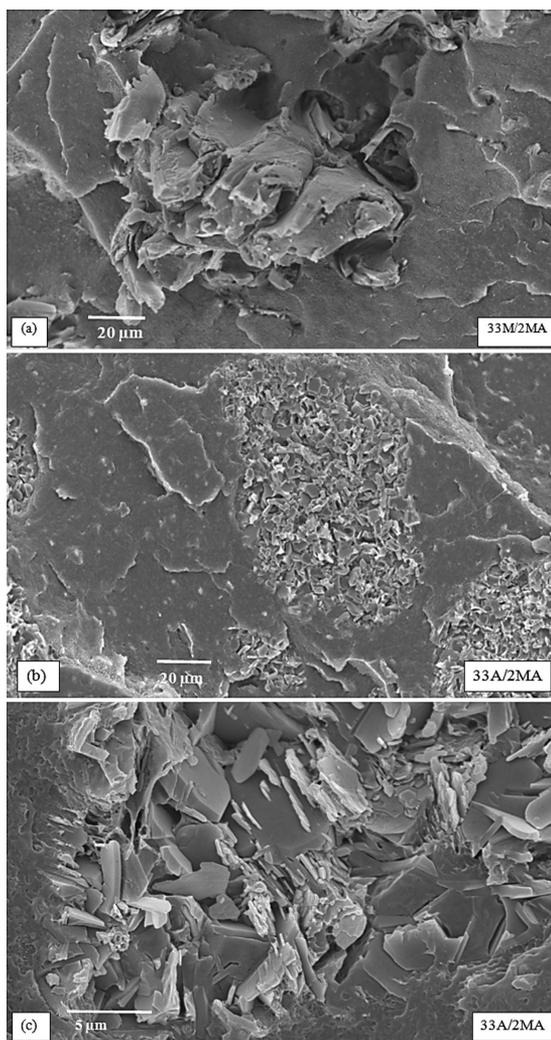
**Figura 1.** Micrografias da região fraturada (a) e (b) com aumento de 1000x para os compósitos de fase única utilizando percentual de 33%, e PEAD-g-MA como compatibilizante e micrografia (c) com aumento de 6000x para o interior do grão de alumina.
