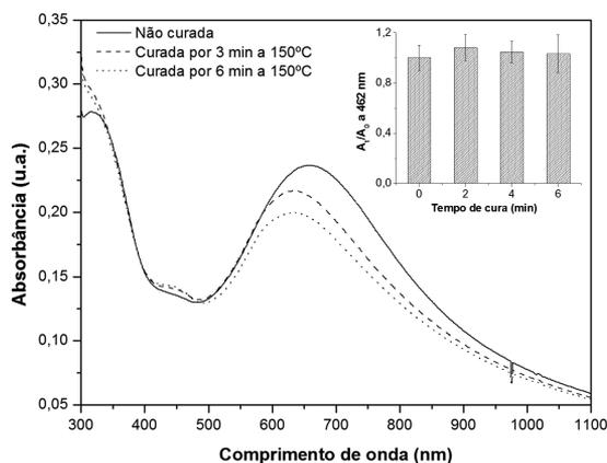
**Figura 3.** Espectros de absorção no UV-Vis para filmes de 15 bicamadas de POEA (CSA)/PF não curados e curados por 3 e 6 minutos a 150 °C e absorbância (normalizada) no ponto isobéstico em função do tempo de cura (parte superior direita do gráfico).
