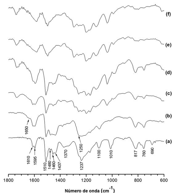
**Figura 2.** Espectros de transmissão por FTIR da: (a) PF não curada; (b) PF curada; (c) POEA+PF curada; (d) POEA+PF não curada; (e) POEA não submetida ao mesmo tratamento térmico de cura da resina PF e (f) POEA submetida ao tratamento térmico de cura.
